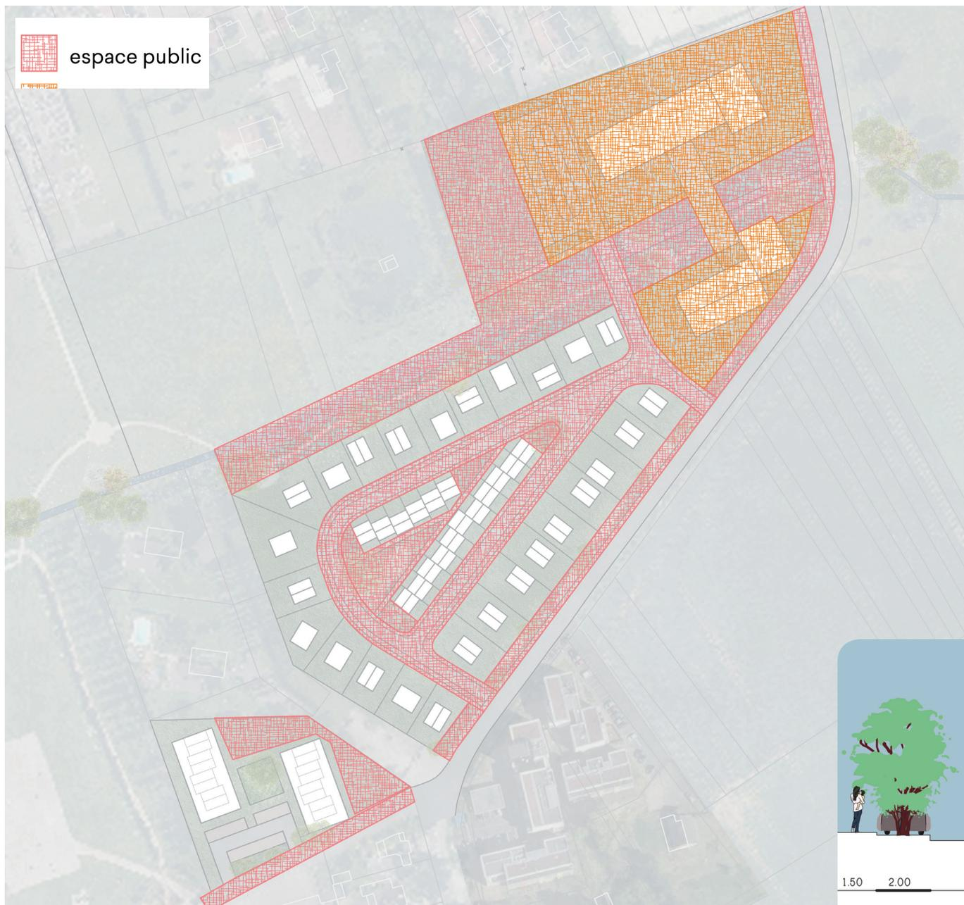
En rose, sont représentés les espaces publics générés par ce scénario. On distingue d'abord les voies nouvellement créées. La partie résidentielle présente un profil en travers de 9 mètres de large, contenant deux trottoirs une bande de stationnement linéaire et une voie de 4 mètres de large. La voie d'accès principal est à 6 mètres avec deux trottoirs de 2 mètres chacun.
