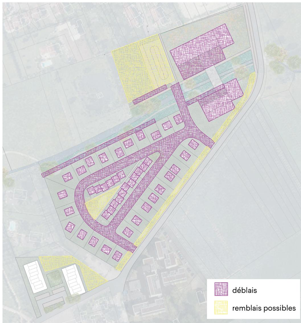
En rose, ce sont l'ensemble des déblais générés par les fondations des futurs bâtiments ainsi que les déblais générés par les VRD et ouvrages hydrauliques; en terrain potentiellement pollué (selon étude fondasol).
