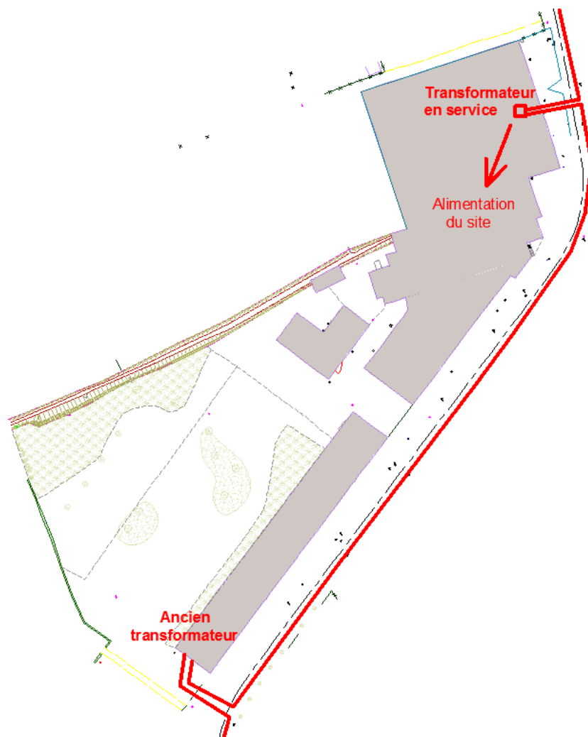
Fig. 7. Réseau électrique existant
