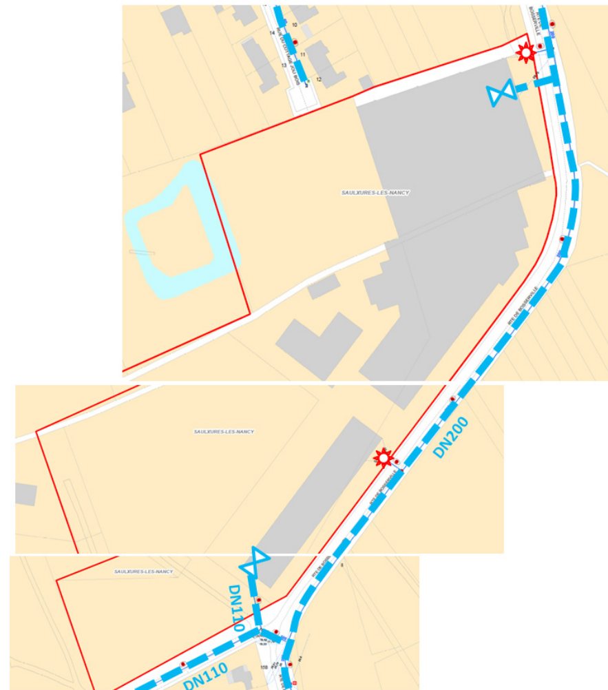
Fig. 6. Réseau d'eau potable
